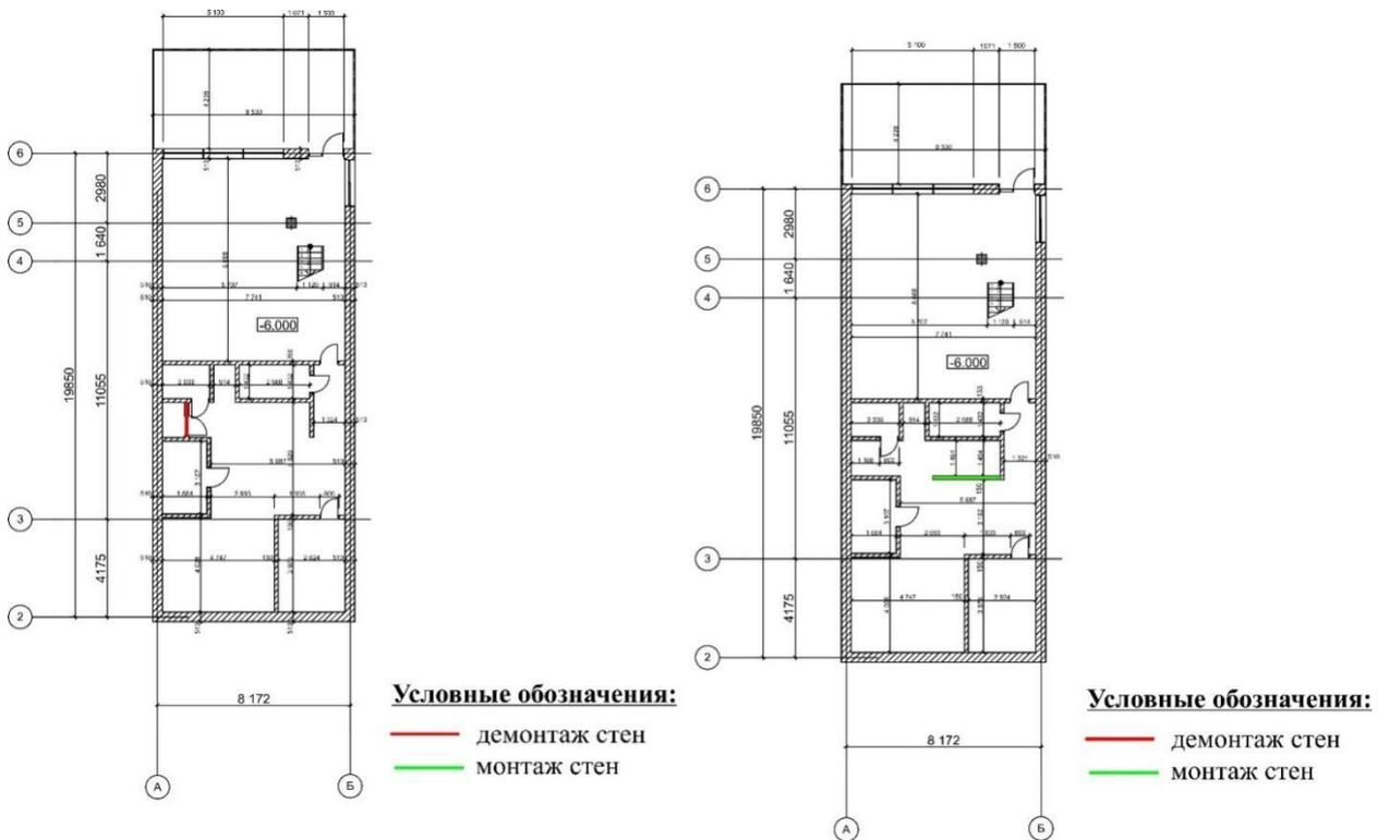
Рисунок 22. План демонтажа и монтажа -2-го этажа на отметке -6.600
